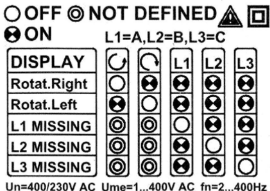
Рисунок 2. Таблица определения фаз (приведена на лицевой панели прибора)
